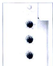
▲一边利用示波器观察波形，一边用位于操作板后面的3个旋钮来调节
